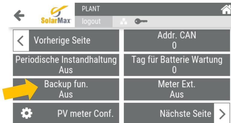
7. Stellen Sie sicher, dass die vorher beschriebenen Einstellungen zur Drei-Phasenkompensation und zum externen Zähler korrekt ausgeführt sind. Siehe hierzu Kapitel 2.1 Drei-Phasenkompensation von Schritt 4 bis einschließlich 10. („Dreiphasig Conf.“ = „An“ sowie „Meter ext.“ = „An“). (\*)
