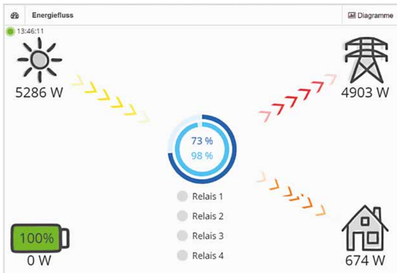
Abb. 33: Energiefluss des MAX.STORAGE
