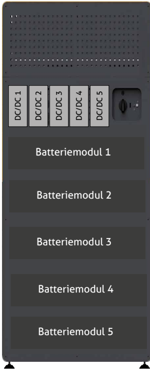
Abb. 18: Nummerierung der Steckplätze für Moduleinschübe
