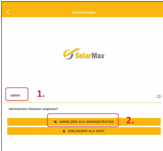
Abb. 23: Anmelden an den Wechselrichter
